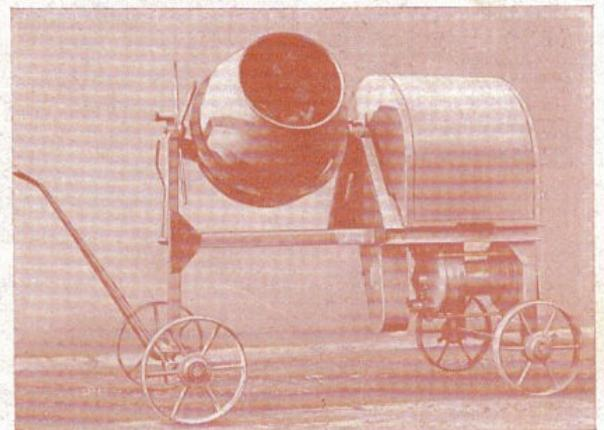
Der bewährte »Koy«-Schnellmischer 75 l Trommelinhalt. Type »Rapid«. Die Leistung beträgt 3 cbm bei 40 Füllungen pro Stunde. Der Antrieb erfolgt durch einen 2,5 PS Fichtel u. Sachs Benzinmotor mit oder automat. Regler oder durch Elektromotor.
