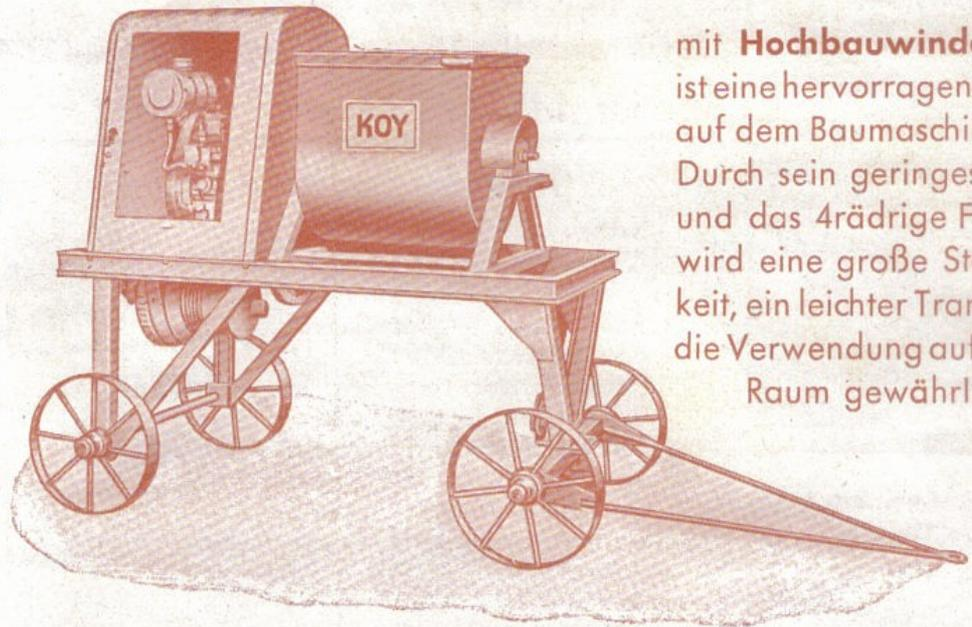
mit **Hochbauwinde**, 300 kg ist eine hervorragend Leistung auf dem Baumaschinenmarkt. Durch sein geringes Gewicht und das 4rädrige Fahrgeste wird eine große Standfestigkeit, ein leichter Transport und die Verwendung auf kleinstem Raum gewährleistet.
